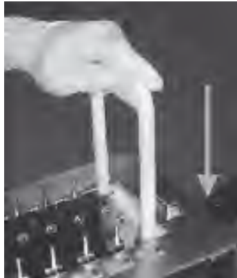
Abbildung 22: Öffnung des Klemmmechanismus
