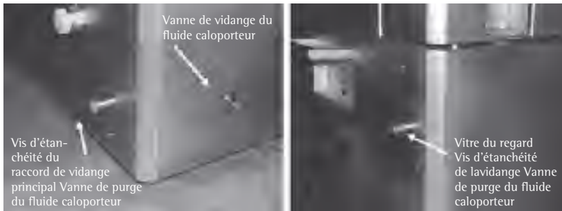
Figure 10 : Vanne de vidange du fluide caloporteur et vis d'étanchéité de CryoPilot A
