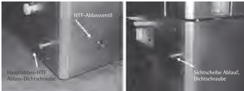
Abbildung 10: HTF-Ablassventil und Dichtschrauben des CryoPilot A
