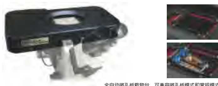
全自动微孔板载物台，可兼容微孔板模式和常规模式
